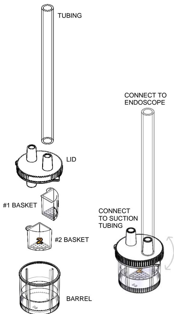
1. CONNECT TUBING ON THE TRAP TO THE ENDOSCOPE AND CONNECT THE SUCTION TUBING TO THE TOP OF THE TRAP. MAKE SURE THE TUBING FROM THE SCOPE IS OVER THE #1 BASKET.
