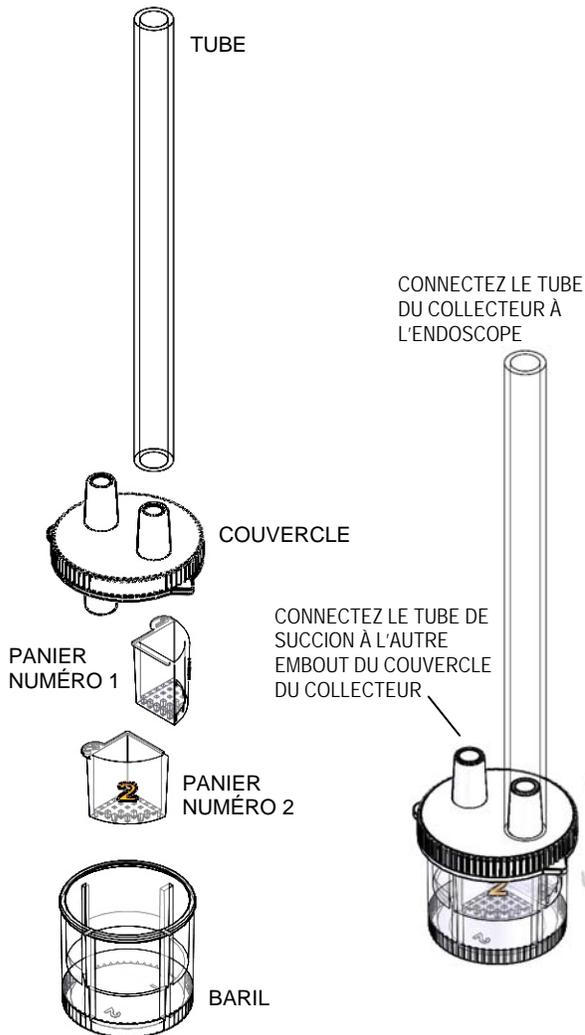
1. Connectez le tube du collecteur à l'endoscope. Connectez le tube de succion à l'autre embout du couvercle du collecteur. Assurez-vous que le tube provenant de l'endoscope soit bien au-dessus du panier numéro 1.
